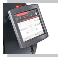
Mobiles Bedientableau mit integrierten Magnethaltern zur flexiblen Befestigung in der Arbeitsumgebung des Bedieners
