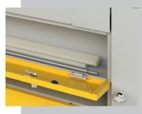
Integrierte Ablagemöglichkeiten für Wechselteile, wie Einlagen, Vorschubstangen und Spannhülsen
